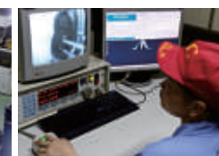
Y.MITS Röntgenanlage zur Reifendurchleuchtung
